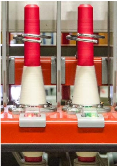
Eğirme pozisyonunun tanımlanması için iki farklı LED
