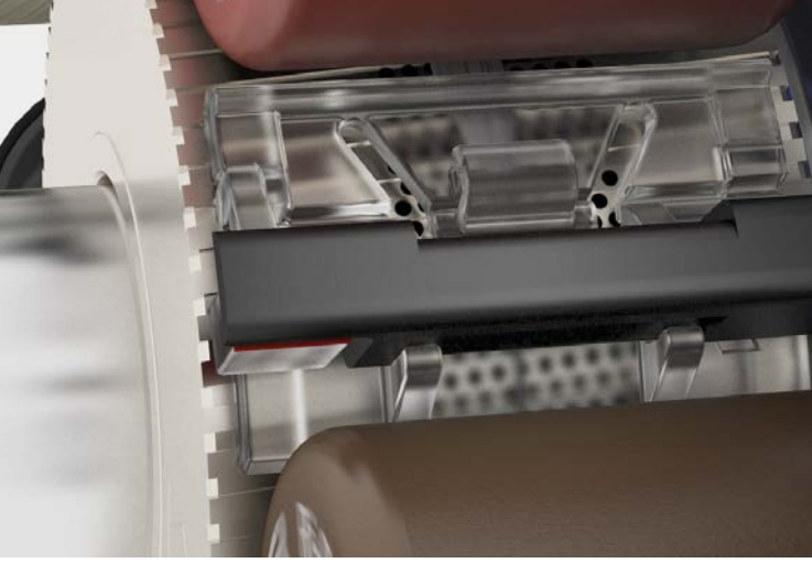
Detect hava kılavuz elemanı üzerinden havayı hedefe yönlendirme
