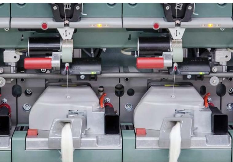
**Abb. 2** Die modernisierte Spinnbox S 36 ermöglicht eine höhere Garnfestigkeit und weniger Imperfektionen.
