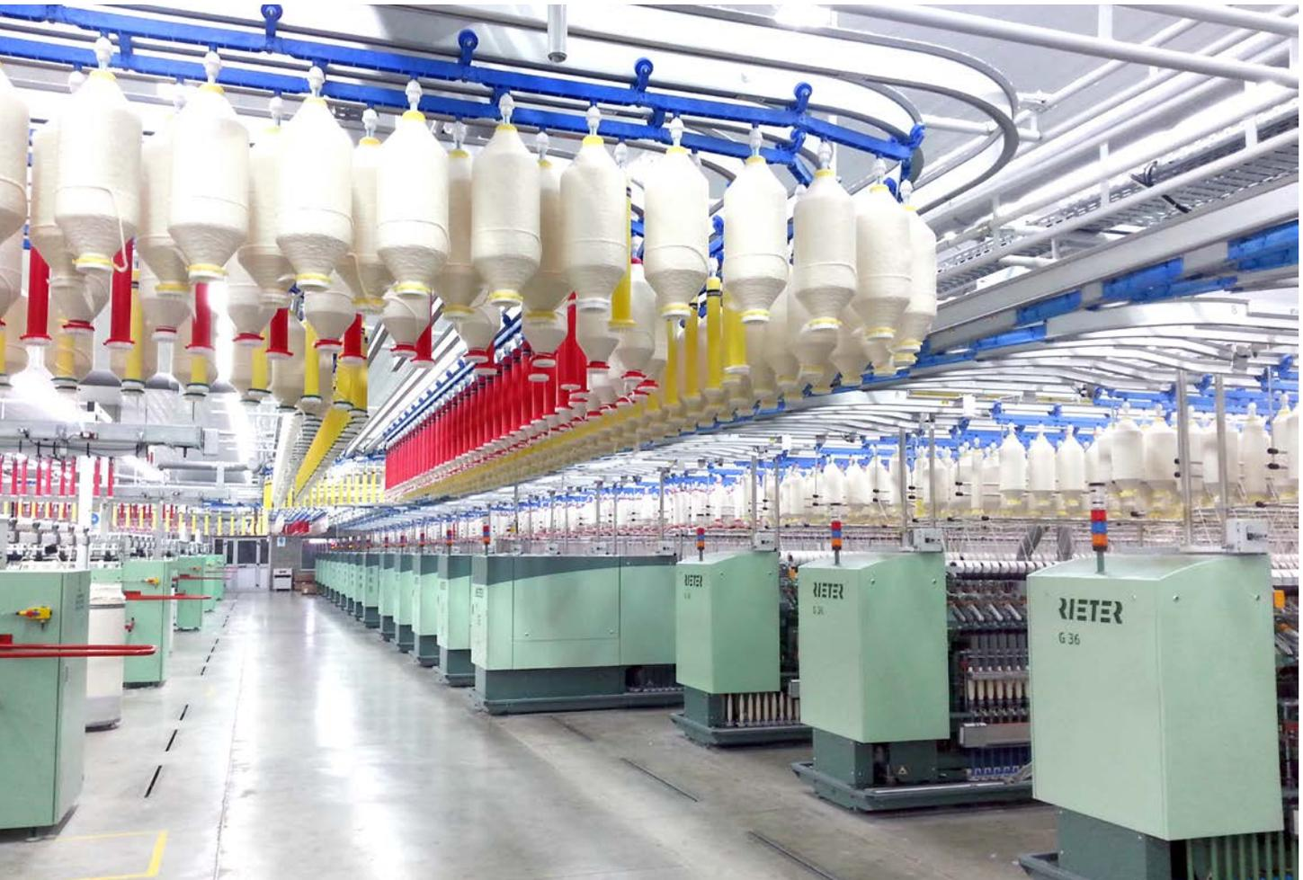
**Abb. 3** Ein perfekter, berührungsloser Spulentransport sichert konstante Qualität.
