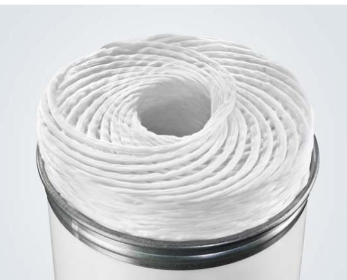
Abb. 5 Saubere Ablage von Polyesterbändern dank des Drehtellers CLEANcoil-PES.
