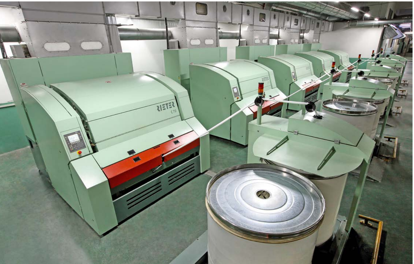
Fig. 1: La carda C 70 produce cinta de carda con excelentes valores de calidad.
