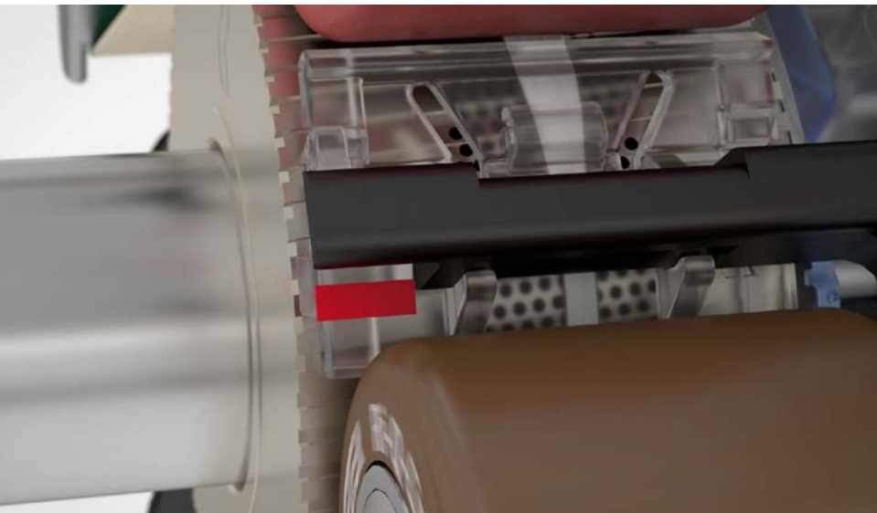
图4：紧密纺纱机的全新气流导向控制元件Dectect可确保稳定的优质纱线质量。
