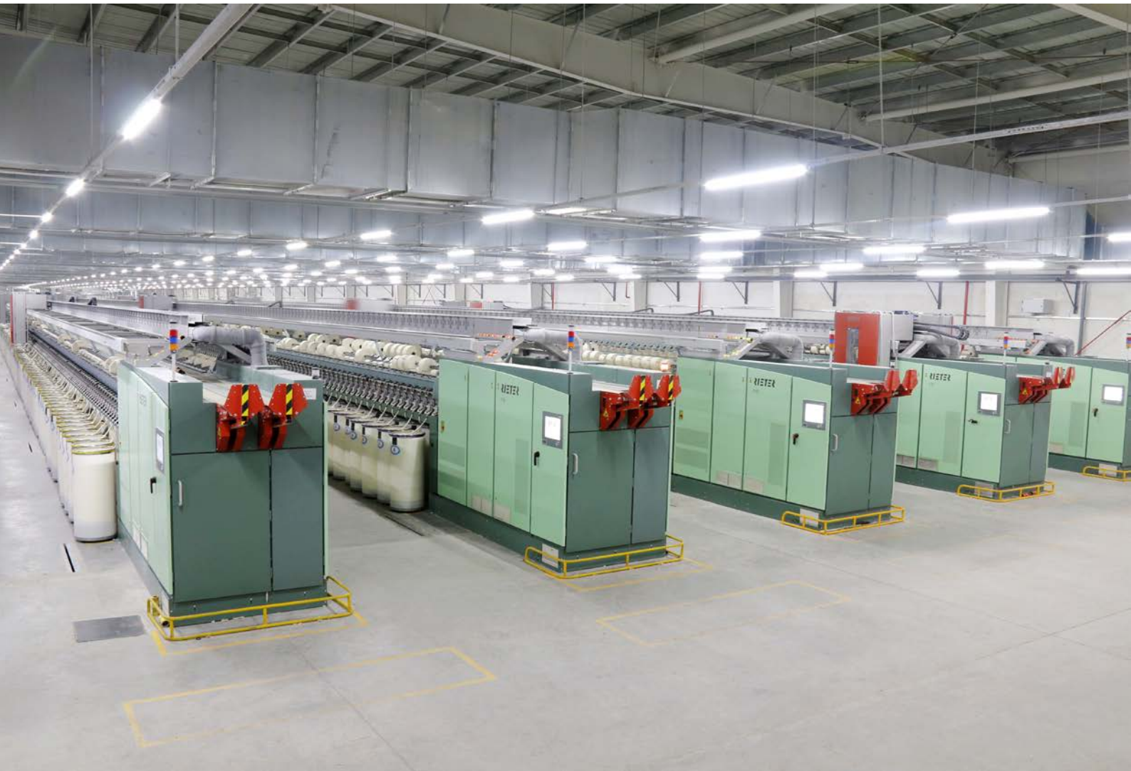
图1：新疆康瑞欣纺织有限公司安装的立达转杯纺纱机R 66：确保优质的柔软针织纱和低生产成本
