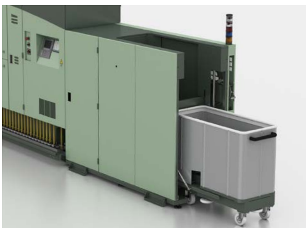
图7：全新纱管装载装置ROBOload“理管器wild loading”可自动分拣空管，大大减少所需的工作量。
