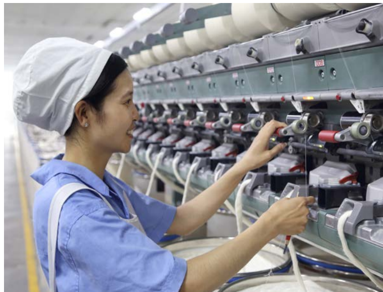
图2：转杯纺纱机R 36具有良好的运行性能，可节约人工成本。
