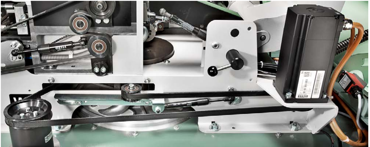
图2：圈条器的伺服电机可以快速优化圈条速度。
