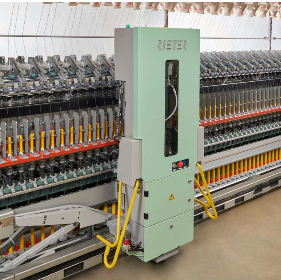
Fig. 1: El empalmador ROBOspin aumenta la productividad y también reduce los costos de personal.
