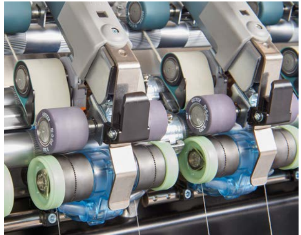
El dispositivo de compactación COMPACTdrum también permite la hilatura económica de hilos compactos de alta calidad en máquinas Rieter existentes.
