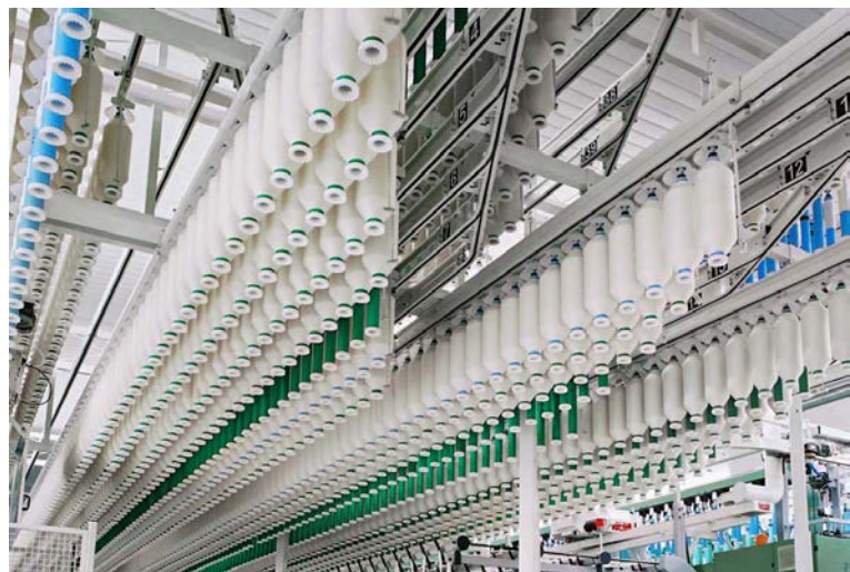
Fig. 3: SERVOTrail automatiza el transporte de bobinas de mecha y ahorra espacio.
