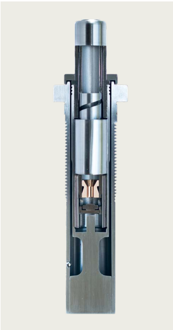
Abb. 2: Die hochpräzise Spindel HPS 28 LENA erreicht bis zu 28 000 Umdrehungen pro Minute.
