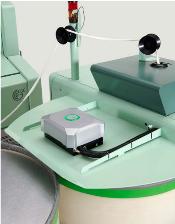
Abb. 2: Trash Level Monitor an der Bandablage der Karde
