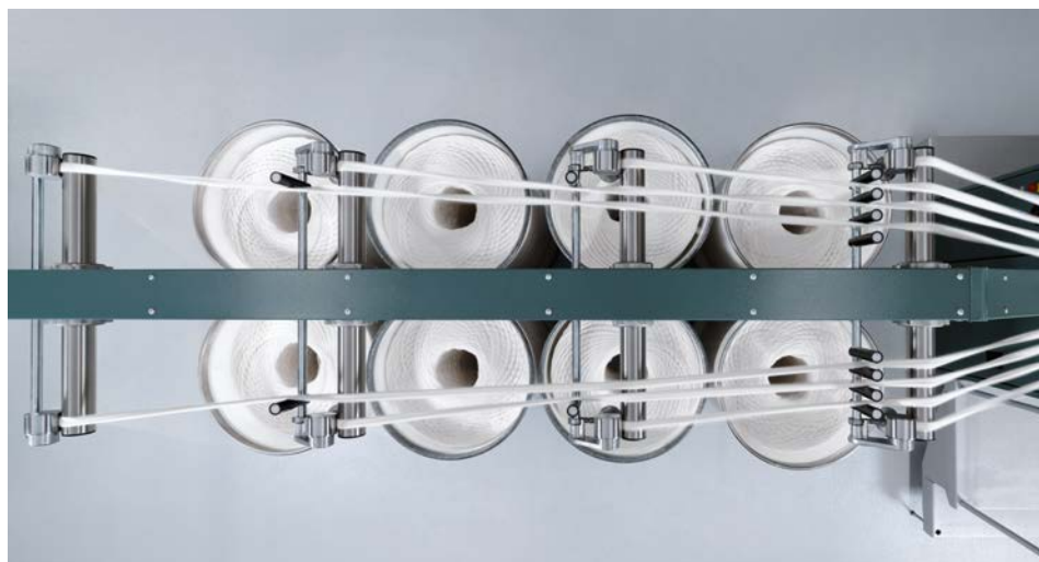
Abb. 2: Verstärkte Walzenführung für verbesserte Robustheit
