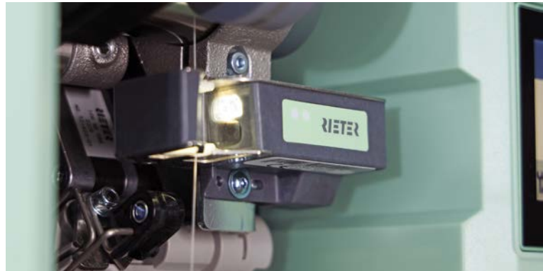
Abb. 5: Garnreiniger Q 30A – die effektive Qualitätskontrolle für luftgesponnene Garne
