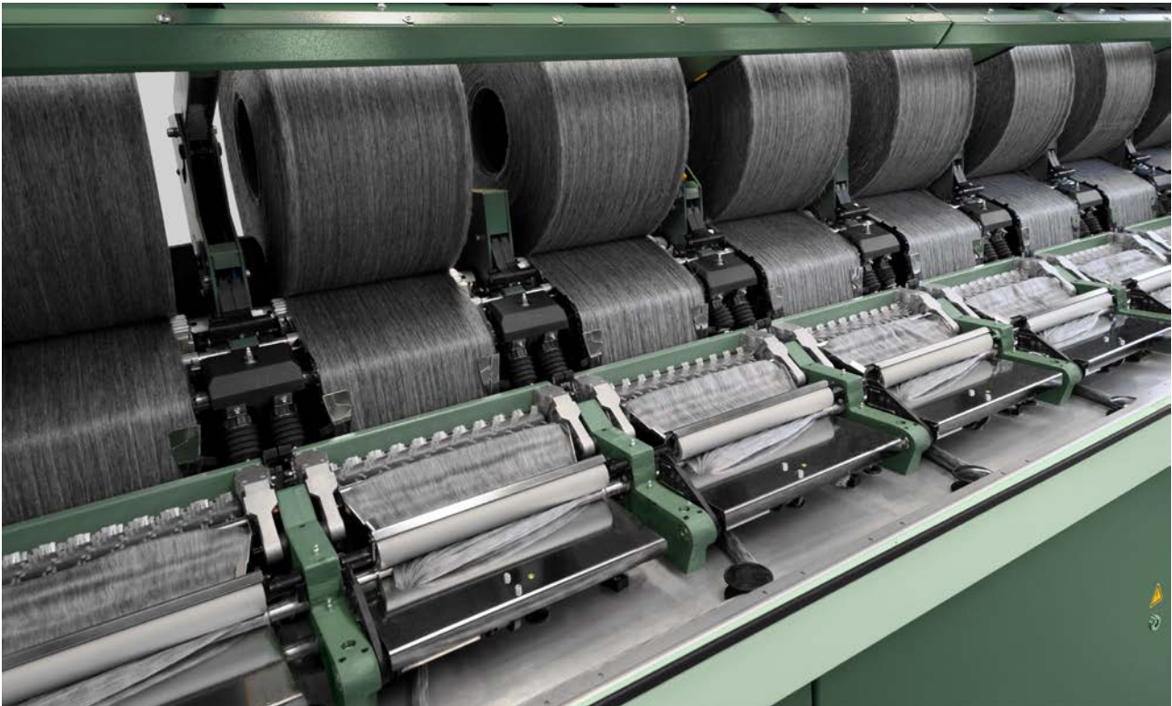
Abb. 1: Störende Kurzfasern und Nissen werden mit der Kämmaschine E 90 ausgekämmt.
