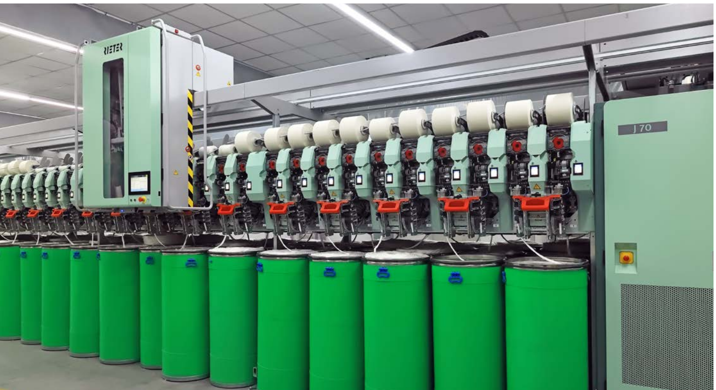
Abb. 1: Die Luftspinnmaschine J 70 mit einzeln automatisierten Spinnstellen
