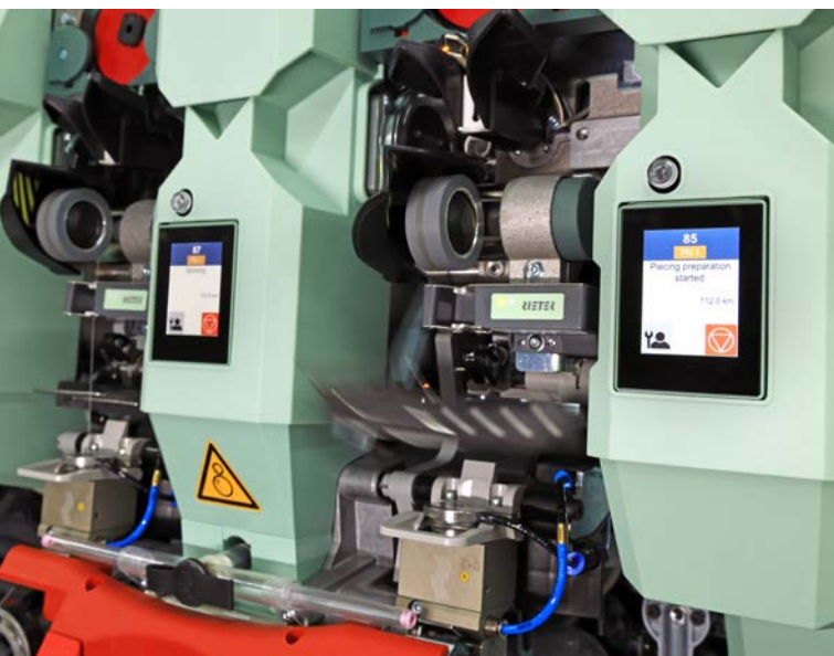
Abb. 4: Vereinfachte Bedienung: ein Display pro Spinnereinheit
