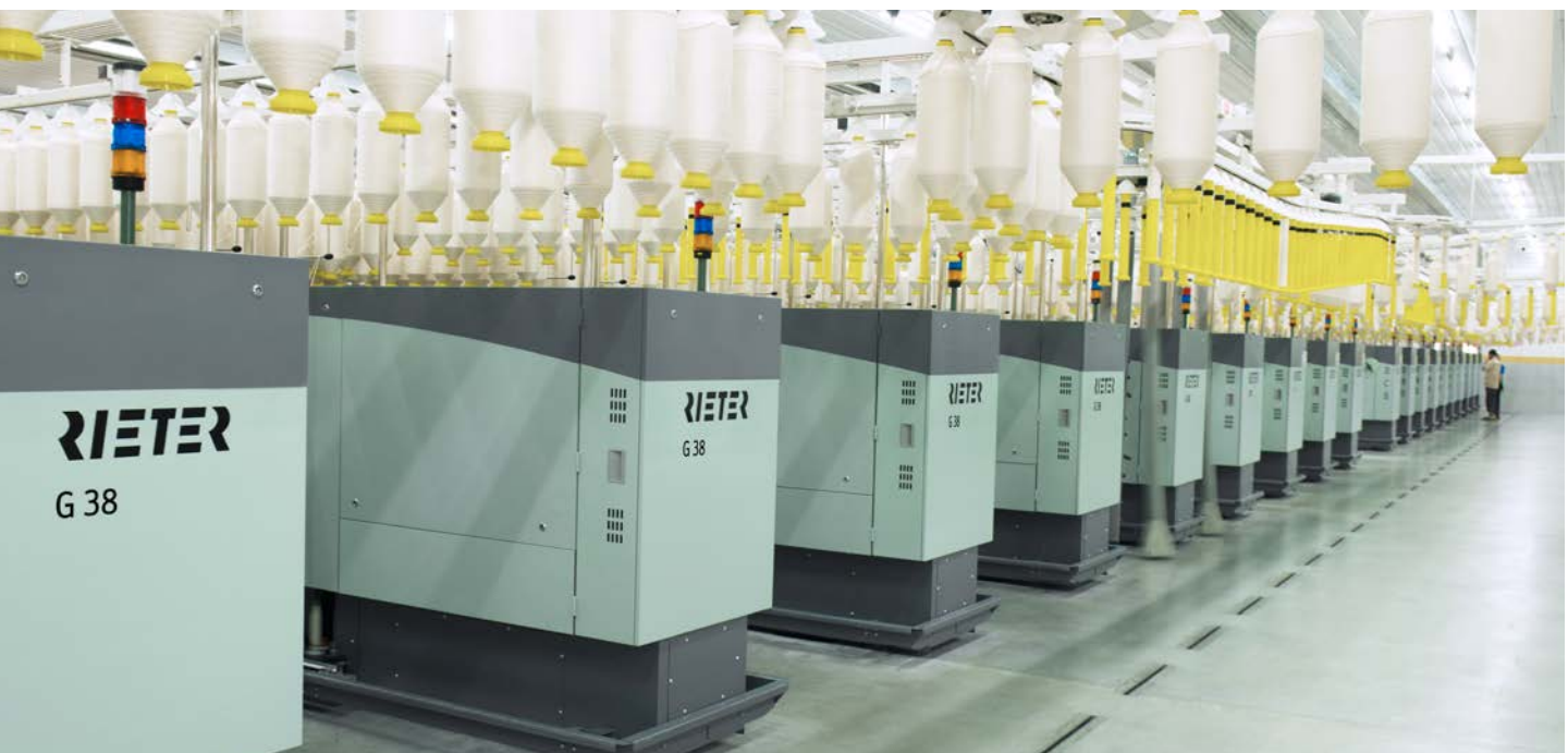
Abb. 1: Die bewährte Ringspinnmaschine G 38 erreicht mit dem High-Speed-Paket eine bis zu 15% höhere Garnproduktion.
