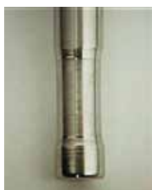
图5：砂砾污染造成的锭杆立轴承磨损的部分
